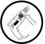
Schlagbohrmaschine mit Betonbohrer Ø10mm
